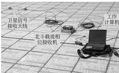
图 3 北斗定向系统构成及延长基线实验图
